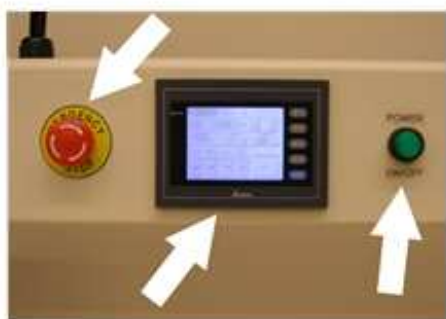
Панель управления, мощность вкл/выкл, аварийная остановка
