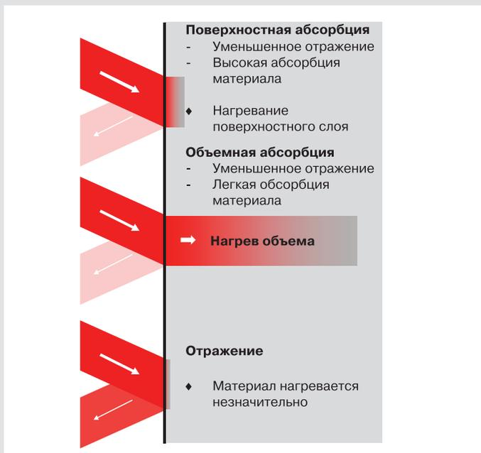
При использовании горячего воздуха и инфракрасных волн средней длины можно получить мощность от 10 до 20 Вт/см<sup>2</sup>, данное значение при использовании коротковолнового инфракрасного или галогенового излучения повышается до 100 – 300 Вт/см<sup>2</sup>. Если возникла необходимость в большей концентрации мощности, необходим лазер, который благодаря лучшей фокусирующей способности может поставлять более 100 000 Вт/см<sup>2</sup>. Высокая точность позволяет осуществлять лишь местный нагрев.
